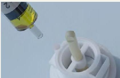
**13.** Questo movimento consente di recuperare completamente la sospensione cellulare mediante aspirazione con la siringa.
