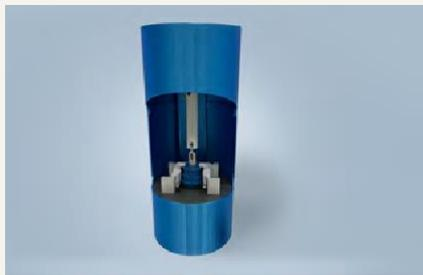
**3.** Coprire il dispositivo con il coperchio in dotazione e inserire il dispositivo nella macchina per la processazione meccanica dei tessuti.
